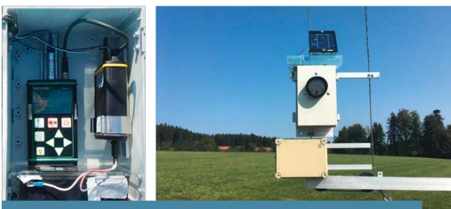
Abb.1a) Position des Messgerätes auf 88 m. 1b) BatUnit mit Batlogger.
