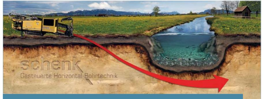
Abb. 3: Prinzip der Horizontalspülbohrung. Quelle: www.schenkag.com.
