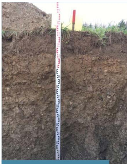
Abb. 1: Bodenprofil beim Standort WEA 1 im Grod: tiefgründige, normal durchlässige Braunerden und Parabraunerden. Das Land wurde hier als Fruchtfolgefläche klassiert.
