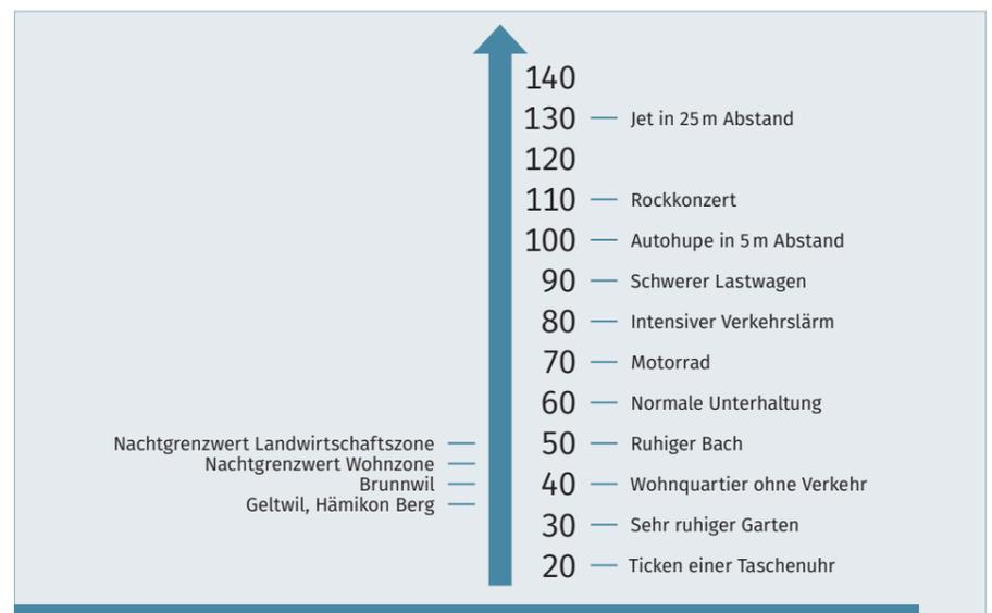
Abb. 2: Wie laut ist das? Die obenstehende Grafik vergleicht Schallbelastungen aus dem Windpark bei Volllast (links des Pfeils) mit Alltagsbelastungen (rechts des Pfeils).
