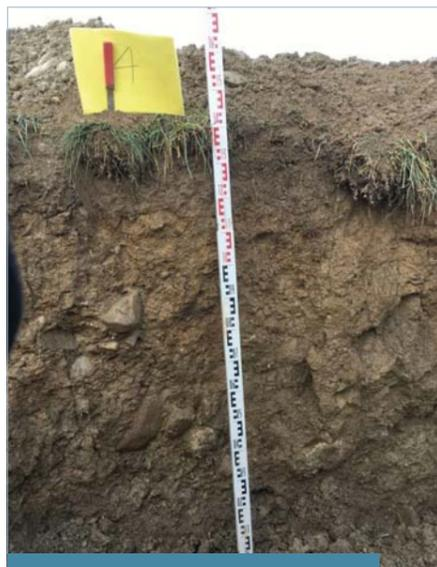
Abb. 2: Bodenprofil beim Standort WEA 3 im Horben: Mässig tiefgründig und teilweise stau- oder hangwasserbeeinflusste (Braunerde und Braunerde-Gley). Das Land wurde hier als Fruchtfolgefläche klassiert.
