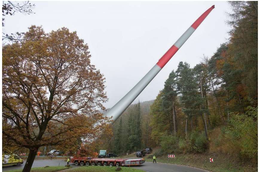
Abbildung 46: Transport eines Rotorblattes mittels eines SPMT (Bild: Mit freundlicher Genehmigung, Windpark Greiner-Eck (D)).
