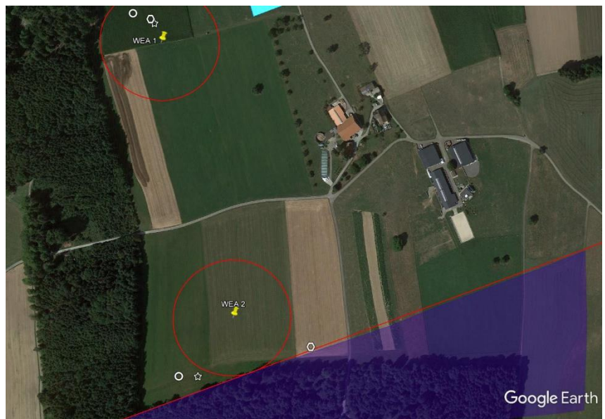
Abbildung 25: Positionierung der WEA 2. Der Rotor überfliegt den Wald nicht. Die Distanz in Nebenwindrichtung zur Anlage WEA 1 beträgt 2.5 Rotordurchmesser. Der vom Rotor überflogene Bereich ist rot dargestellt. Der weisse Kreis zeigt den Fusspunkt von WEA 1, Layout 1, das Sechseck von Layout 2 und der Stern von Layout 4. Die violette Zone ist Teil der Lücke zur Sicherstellung der Funktionalität des Wetterradars Albis. Bild: Google Earth. Darstellung nicht massstäblich.
