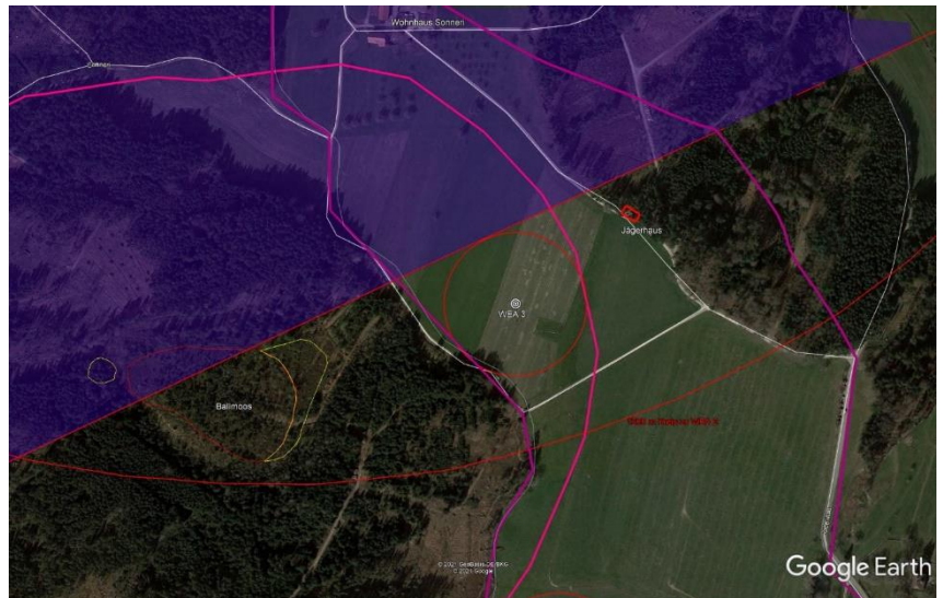
Abbildung 30.: Hochmoor Ballmoos Lieli mit dem vorgeschlagenen 300 m Schutzpuffer (altrosa). Die WEA 3 steht im Norden mit dem Rotorkreis direkt an der vom Meteororadar Albis beanspruchten Zone an. Das Wohnhaus Sonneri befindet sich am oberen Bildrand (Darstellung AEW auf Google Earth).
