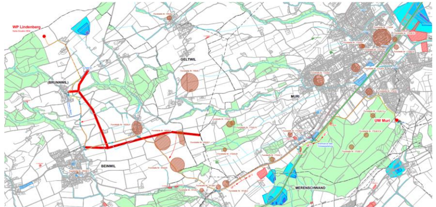
Abbildung 52: Lokalisierung der heute bestehenden Mittelspannungsfreileitungen, die erdverlegt werden (rot). Die Leitungen haben eine Gesamtlänge von 3.3 km. Die orange dargestellte Leitungstrasse entspricht der gewählten Variante der Netzanbindung des Windparks. Sie wird ebenfalls erdverlegt.
