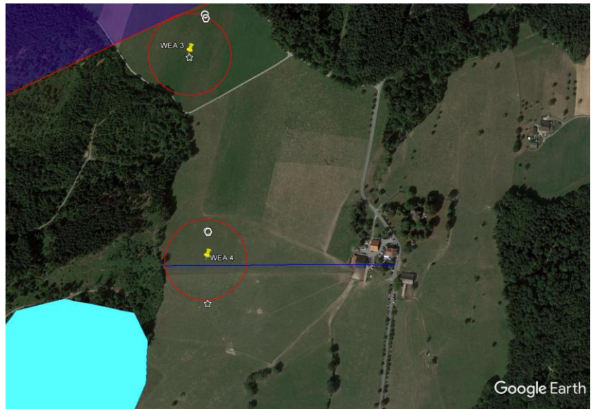
Abbildung 27: WEA 3 und WEA 4 im Teilgebiet Horben. WEA 4 grenzt an ein Gebiet, das im Winter intensiv durch Langläufer genutzt wird (südlich der blauen Linie). Die WEA 4 wurde so positioniert, dass sie möglichst ausserhalb dieses Gebietes zu liegen kommt. Der Abstand der beiden WEA in Nebenwindrichtung beträgt 2.6 Rotordurchmesser. Bild: Google Earth. Darstellung nicht massstäblich.
