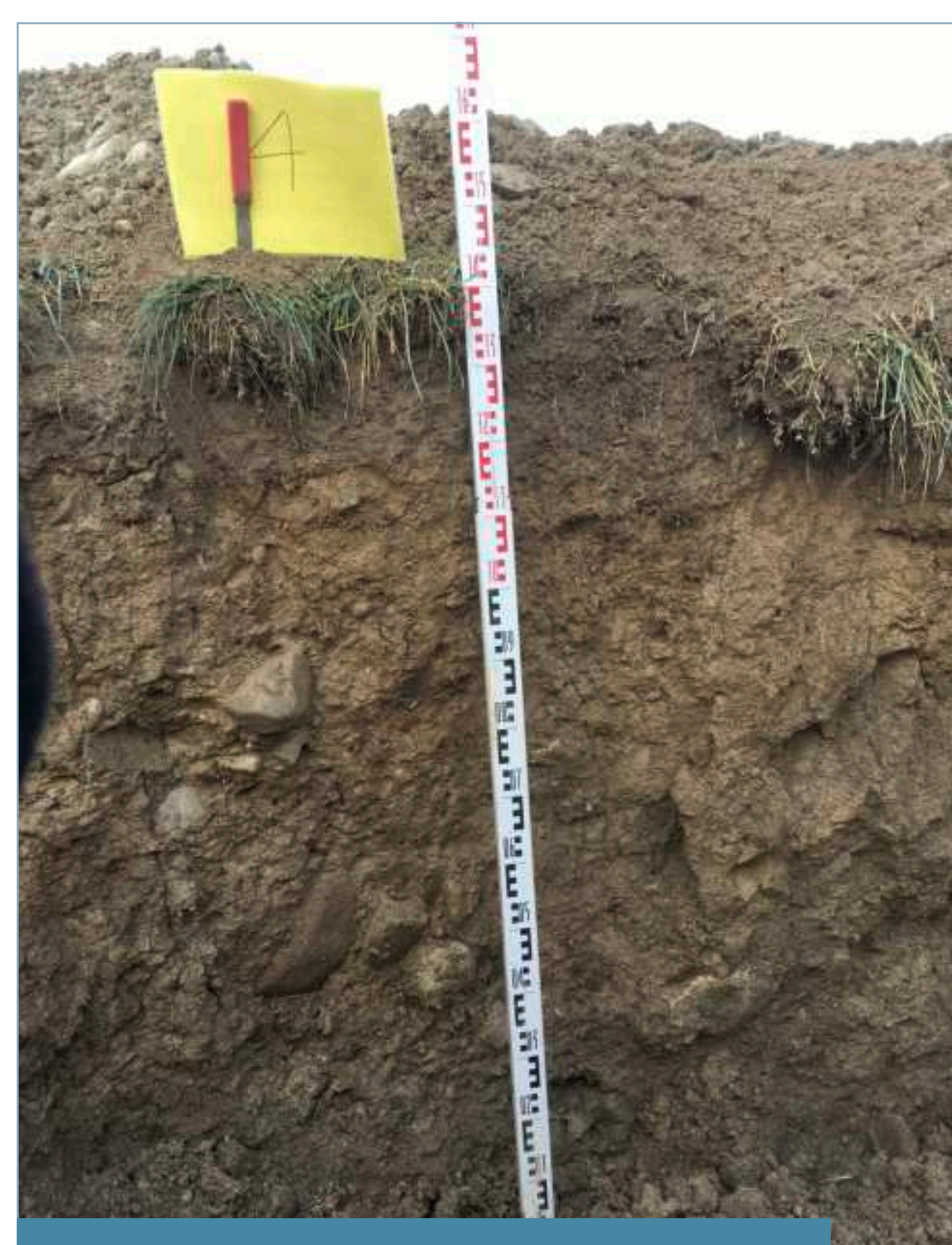
Abb. 2: Bodenprofil beim Standort WEA 3 im Horben: Mässig tiefgründig und teilweise stau- oder hangwasserbeeinflusste (Braunerde und Braunerde-Gley). Das Land wurde hier als Fruchtfolgefläche klassiert. Quelle: Dr. Heinrich Jäckli AG, Baden.
