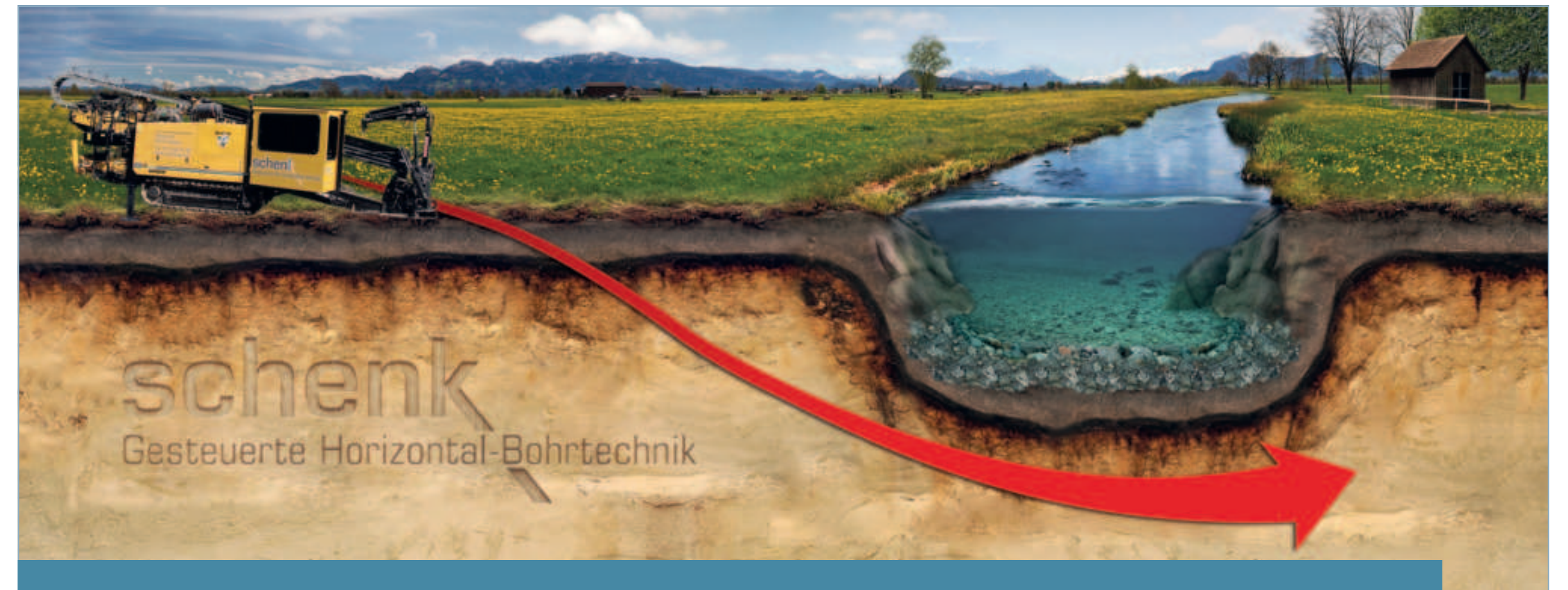
Abb. 3: Prinzip der Horizontalspülbohrung. Quelle: www.schenkag.com.
