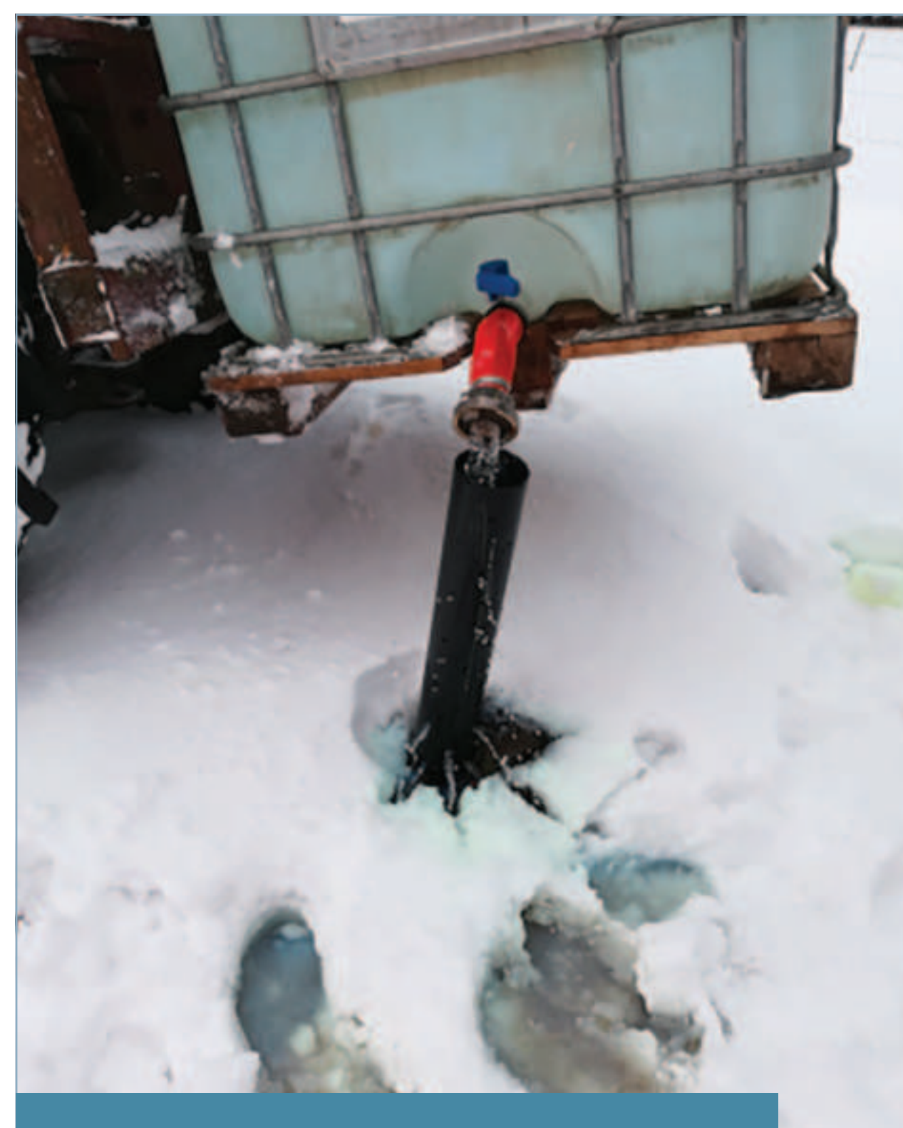
Abb. 1: Einschwennen des Markierstoffes am 28. Januar 2019. Quelle: Dr. Heinrich Jäckli AG, Baden.
